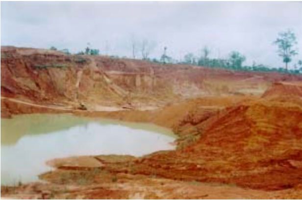
Figura 5. Desmonte hidráulico em cata garimpeira. Mina de Bom Futuro.
